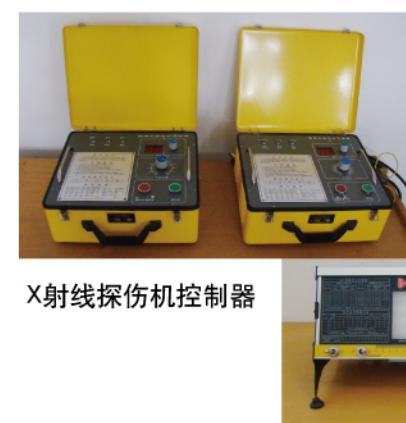
X射线探伤机控制器
