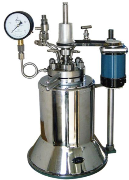
压力容弹(水热合成反应釜)
