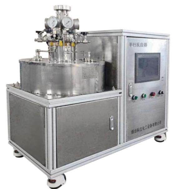
高速反应釜(转速可达5000RPM)
