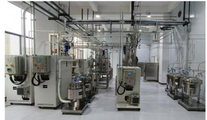
滴球成形老化试验装置
