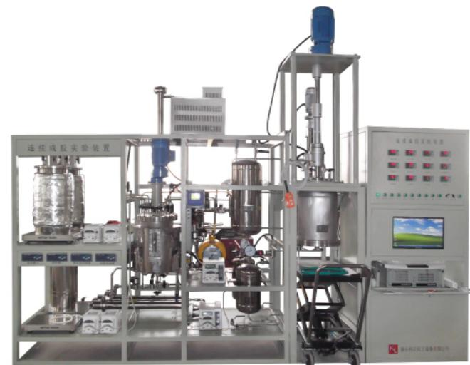
釜式喷射循环反应装置
